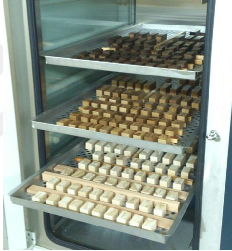
Şekil 4.9. Örneklerin iklimlendirme dolabında kondisyonlanması.
