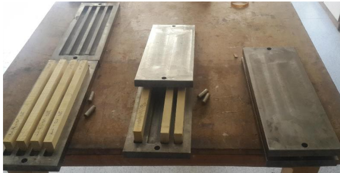
Şekil 4.6. Metal kalıplar ve örneklerin yerleşimi.
