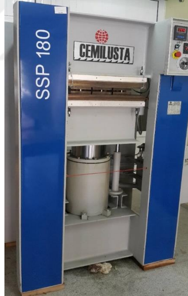
Şekil 4.4. Yoğunlaştırma işlemlerinde kullanılan test presi.
