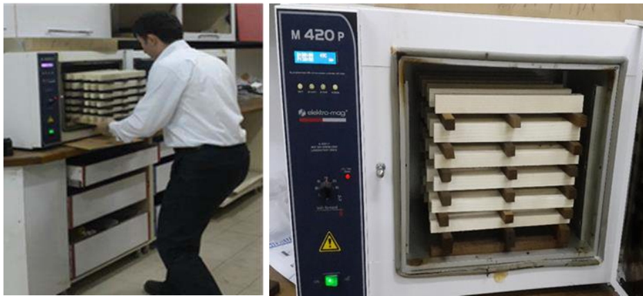
Şekil 4.3. Örneklerin etüv cihazına yerleştirilmesi.
