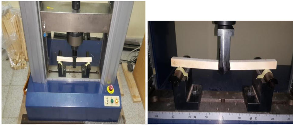
Şekil 4.11. Statik eğilme direnci testi.
