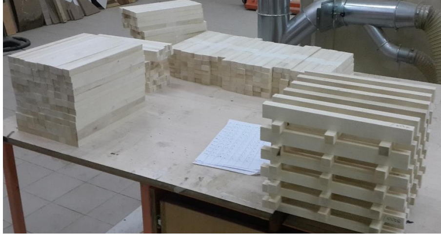
Şekil 4.2. Isıl işlem öncesi kaba ölçülerde kesilmiş örnekler.
