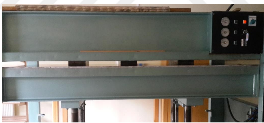
Şekil 4.8. Örneklerin basınç altında soğutulması.
