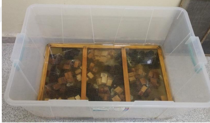
Şekil 4.10. Deney örneklerinin su içerisinde bekletilmesi.
