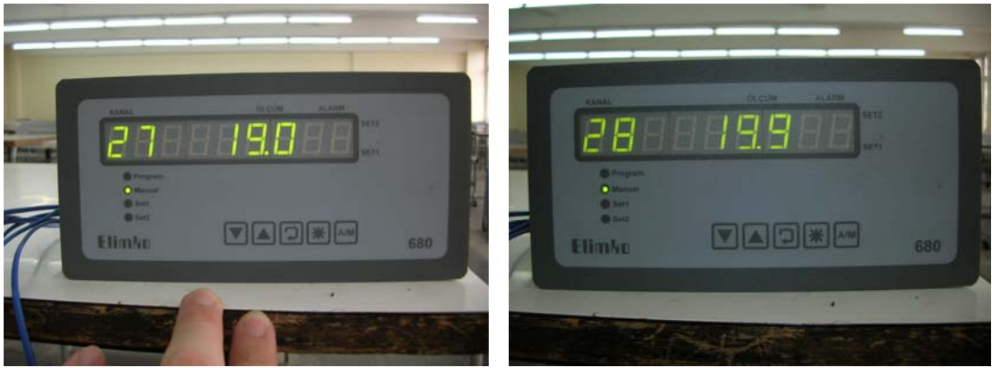
Resim 6.4. 0,2 m yükseklik için sıcaklık değerlerinin veri toplama cihazından okunması
