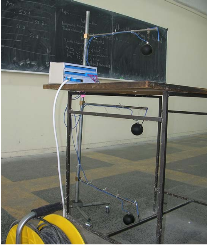
Resim 6.1. Sıcaklıkların ölçümü için deney düzeneği
