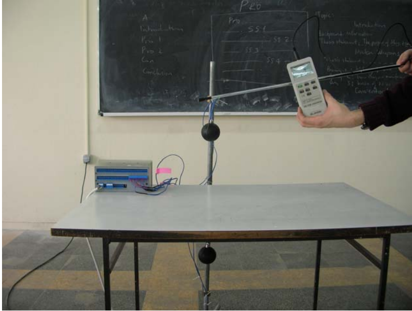
Resim 6.3. Hava hızı ölçümü için anemometrenin kullanımı
