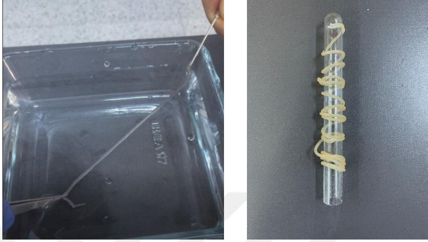
Şekil 2.5 Lif Çekim İşlemi ve Elde Edilen Katkısız Lifler (Kişisel Arşiv, 2021)
