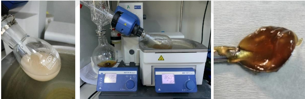
Şekil 2.4.Rotary evaporatörde vakum ortamında lif çekim çözeltisinin hazırlanması ve lif çekim çözeltisi (Kişisel Arşiv, 2020)
