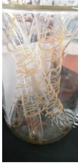
Şekil 2.8. Halloysite nanokil içeren lifler (Kişisel Arşiv, 2021)
