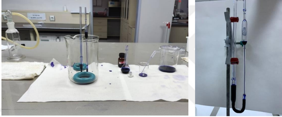
Şekil 2.1. Oswald viskozimetresi ile polimerizasyon derecesi ölçümü (Kişisel Arşiv, 2021)
