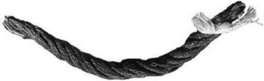
Şekil 3.37: Silikon yağı uygulama sonrası Si-1 halatı.
