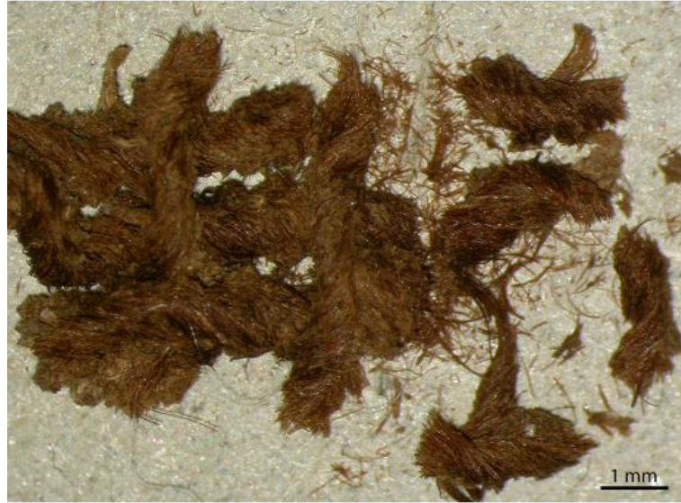
Şekil 2.2: Bozulmuş halde olan Lonne Hede yün lifi.
