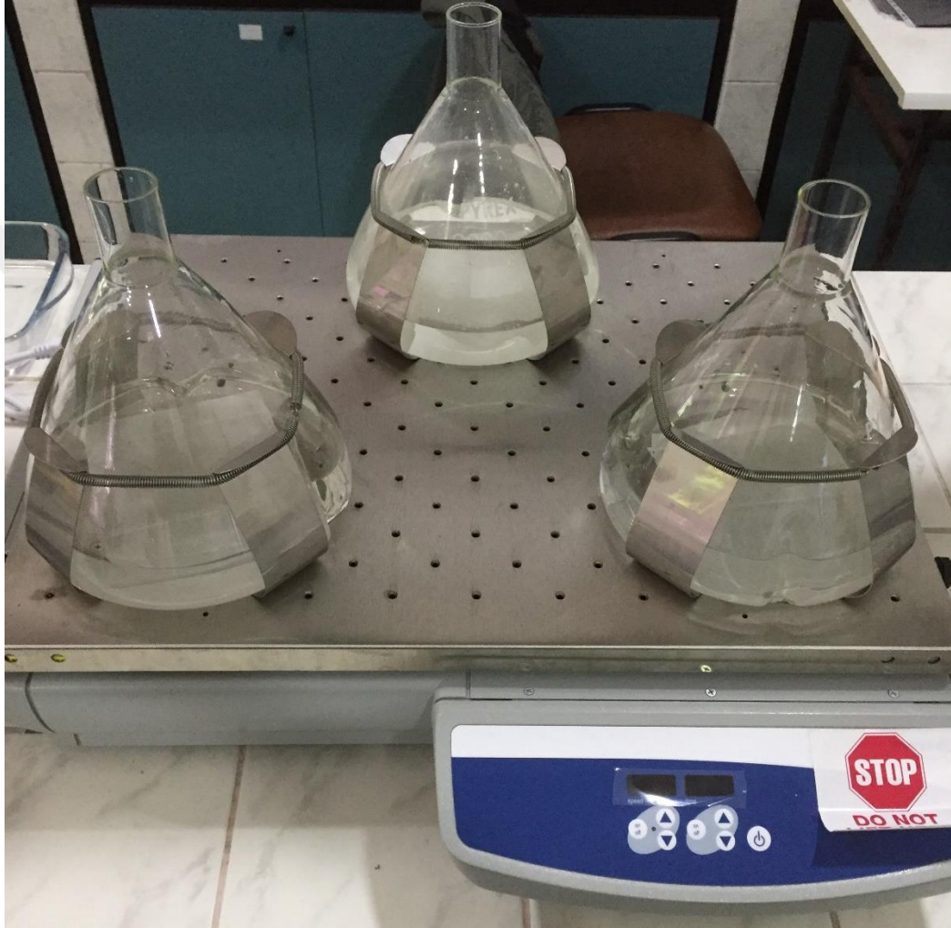
Şekil 3.1. Orbital karıştırıcı ve 2,8 L hacimli Fernbach erlenleri
