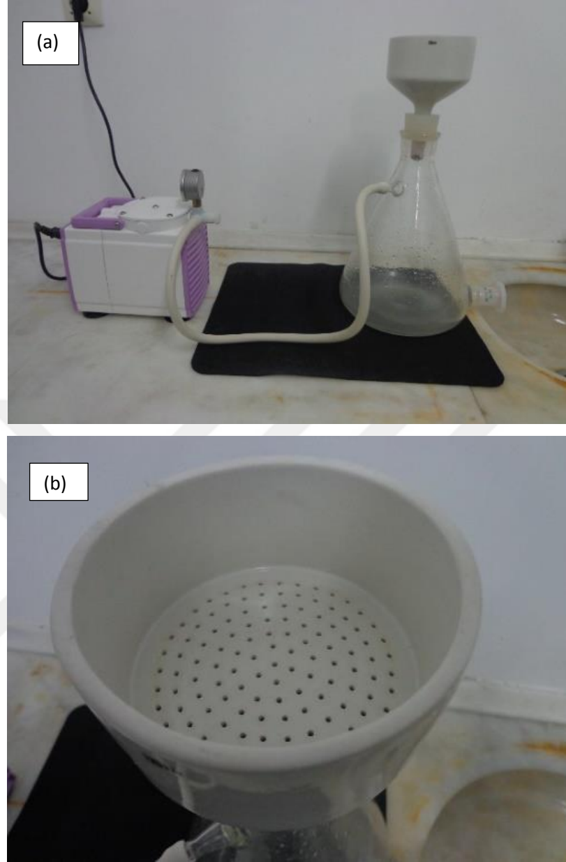
Şekil 3.4. Filtrasyon düzeneği, (a) vakumlu filtrasyon sistemi, (b) filtre kağıtlarının içerisine yerleştirildiği porselen süzgeç
