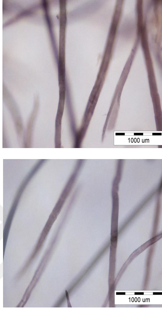
Şekil 4.8. Klozete Atılabilir (Flushable) türden ve Avrupa ülkelerinden elde edilen bir ıslak mendil numunesinin Herzberg Fiber boya ile boyanması sonucunda, fiber türlerinin ışık mikroskopunda elde edilen görüntüleri
