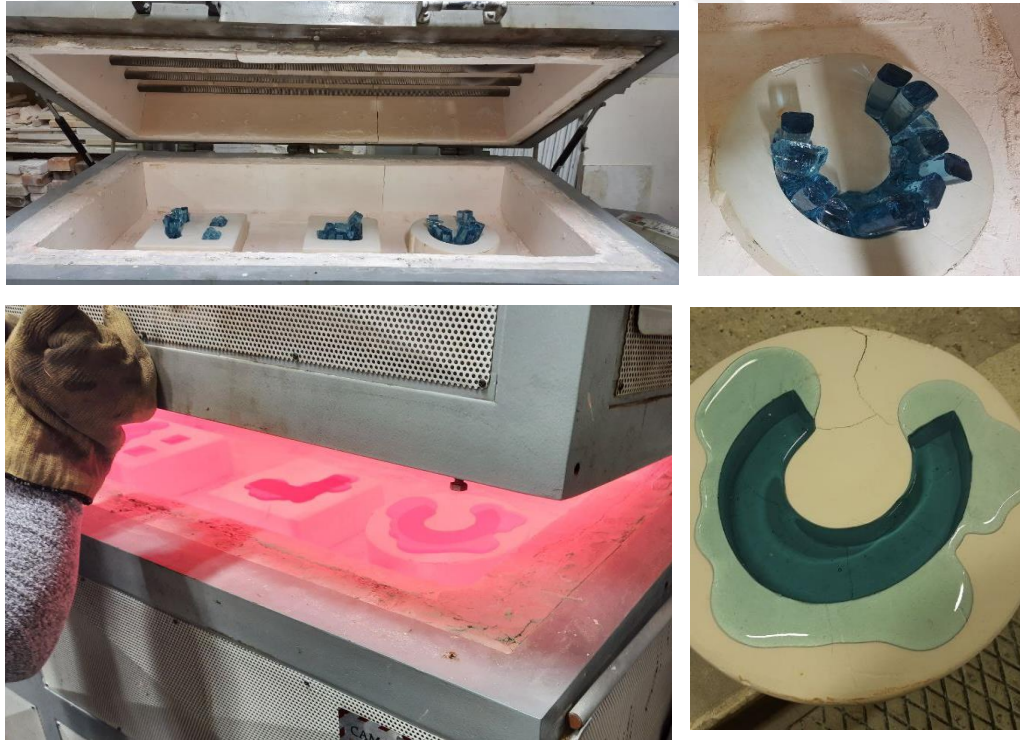
Görsel 4.5. Camların kalıba yerleştirilmesi ve fırınlanması
