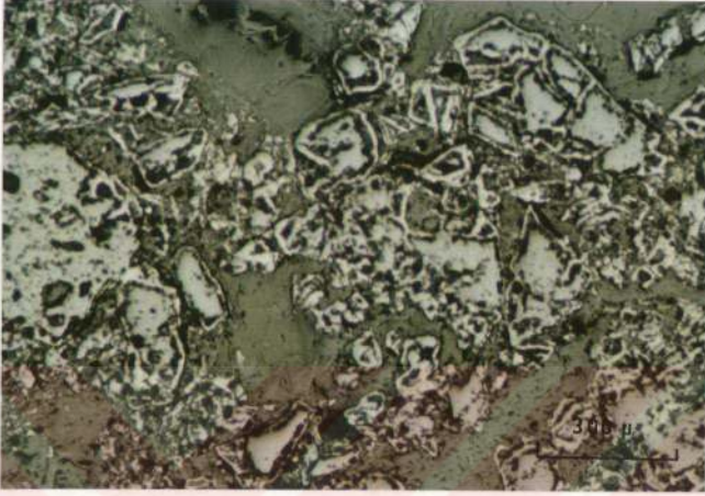
Şekil. 6.4. Kromitlerin (mavimsi gri) kenarları boyunca hematite (açık gri) dönüşmelerin mikroskopta görünümü. T.N. X 100
