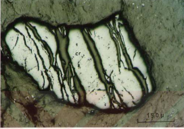
Şekil. 6.3. Kataklasma sonucu kromit kristallerindeki parçalanma ve uzamanın görünümü. cr: kromit, T.N. X 200
