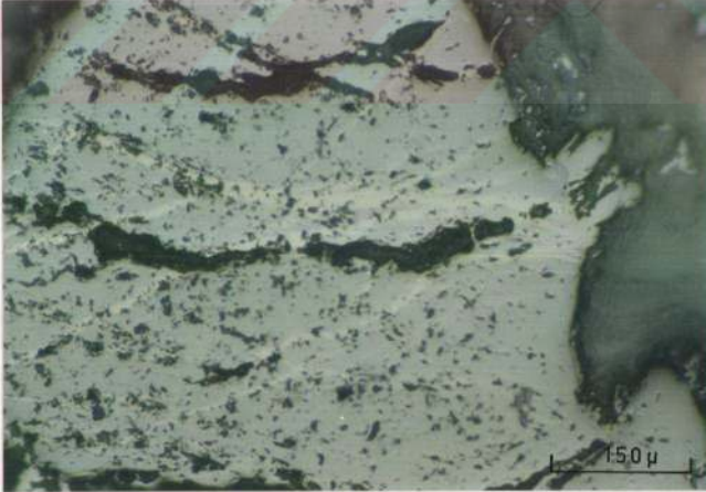
Şekil. 6.5. Kromitlerin ( Mavimsi gri) çatlakları boyunca hematite (açık gri) dönüşmesi T.N. X 200
