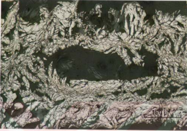
Şekil. 6.33. Keçemsi yüzeyli piritlerin mikroskopta görünümü. T.N. X 200
