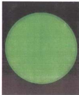
Şekil 3.10. 3HF katkılanmış PS özlü SciFi'nin kesiti (Atac, 2002)
