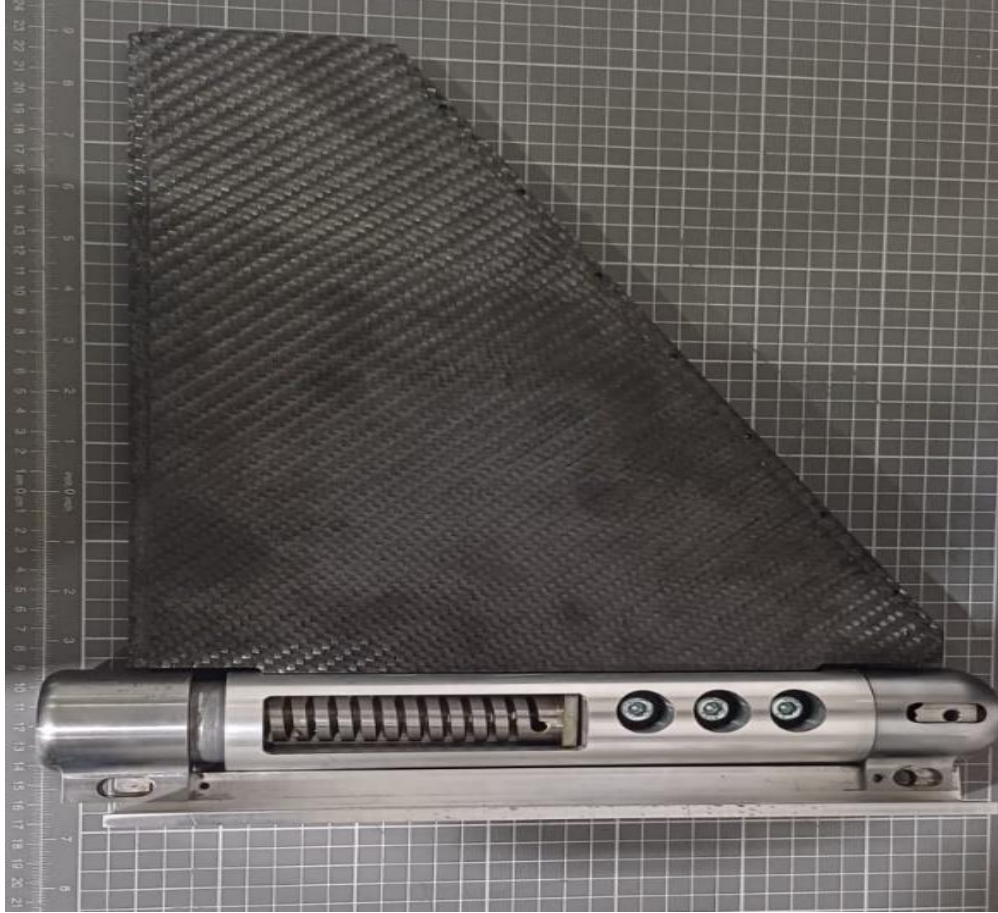
Şekil 3.23. Katlanır kanat mekanizması montajlanmış versiyonu
