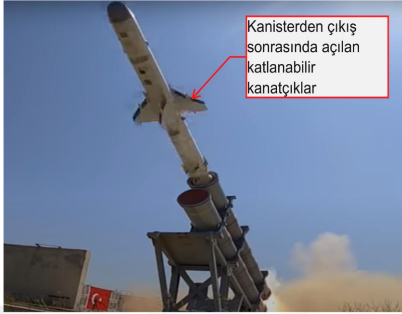
Şekil 1.3. Katlanabilir kanatçıkların kanisterden çıkış sonrasında açılması
