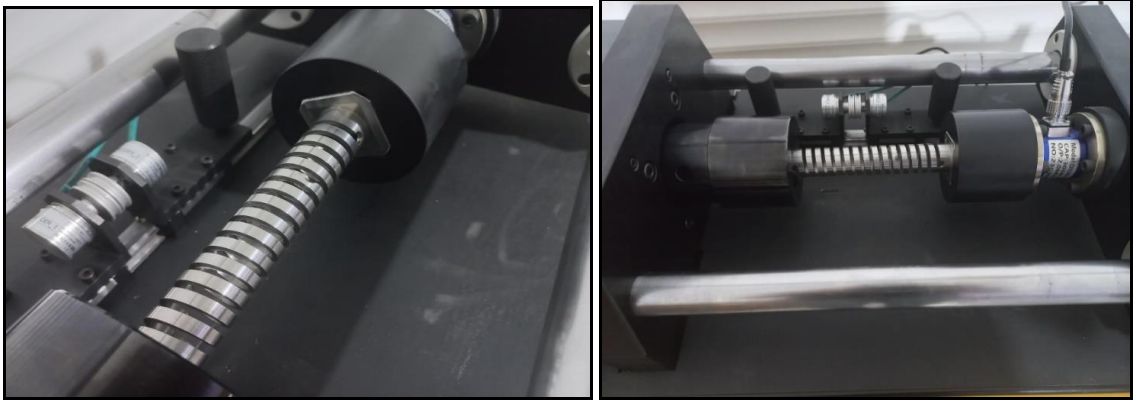
Şekil 3.14. İşlenmiş yayların testlerinin yapılması
