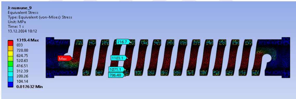
Şekil E.1.9 9 numaralı yayın numerik kesit gerilmeleri ve tork ölçüm sonucu
