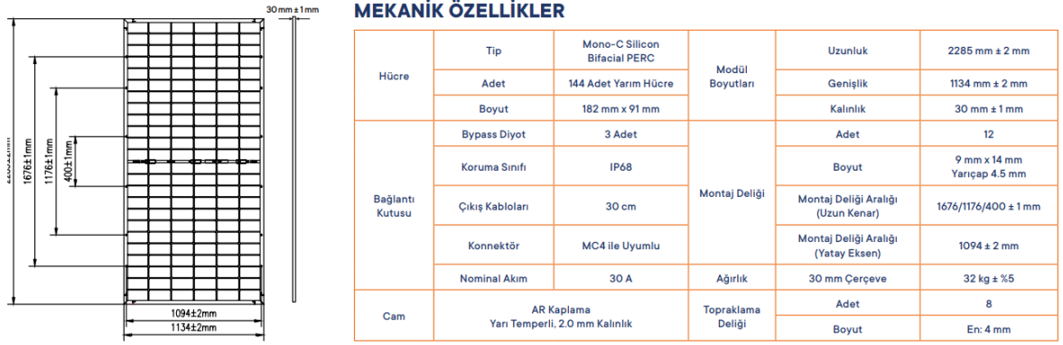
Şekil 33. Güneş Panelinin Mekaniksel Özellikleri (Kalyon PV, 2024)
