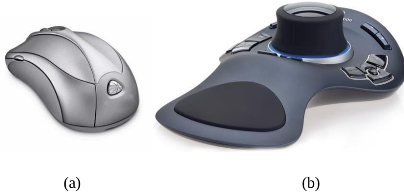
Şekil 4.6 (a) Genel kullanıma yönelik bir fare, (b) 3 boyutlu fare
