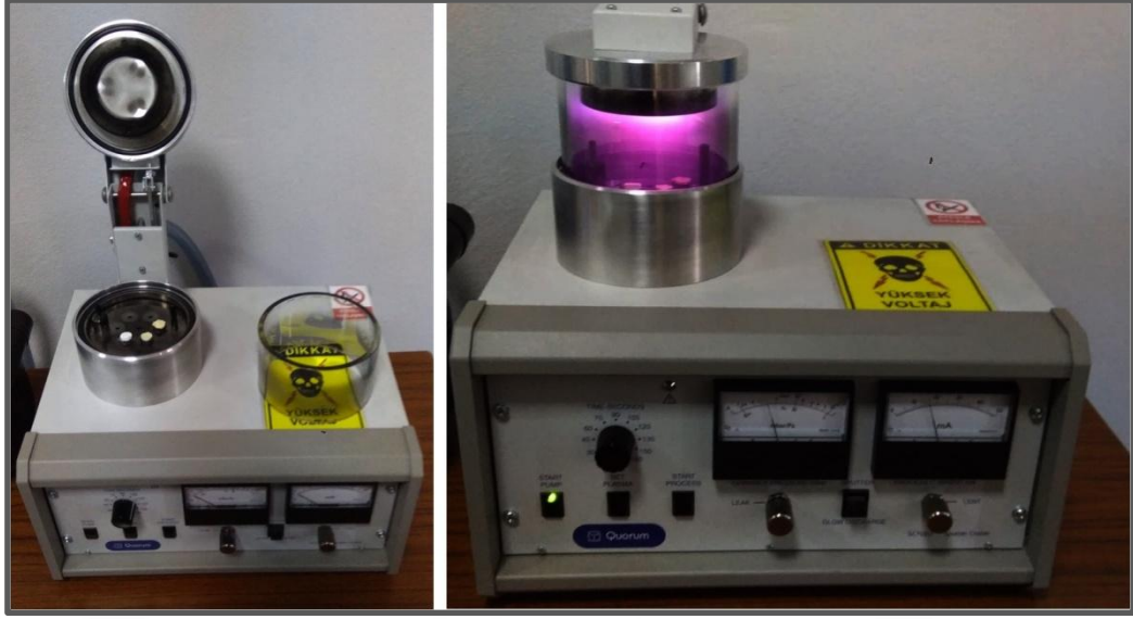
Resim 3. Altın kaplama cihazı ve örneklerin kaplanma aşaması
