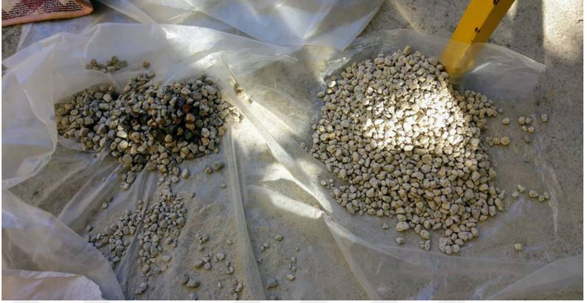
Görsel 3.1. Pomza taşlarının içindeki yabancı taşların ayrılması
