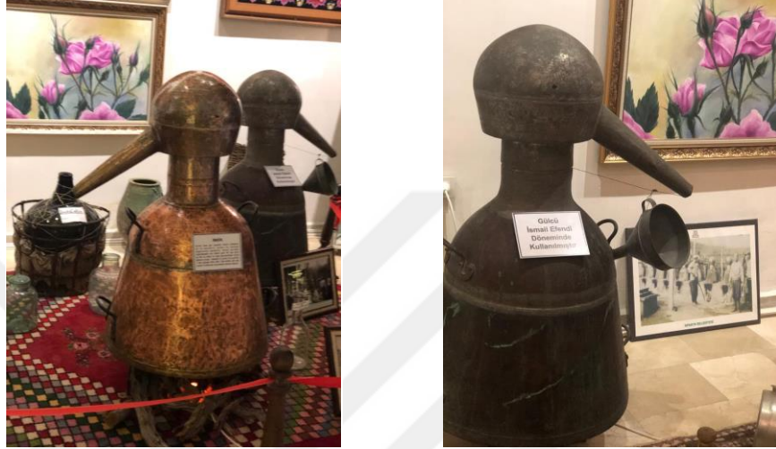
Resim 2. Gül Yağı Üretimindeki İmbikler (Budak, 2021)
