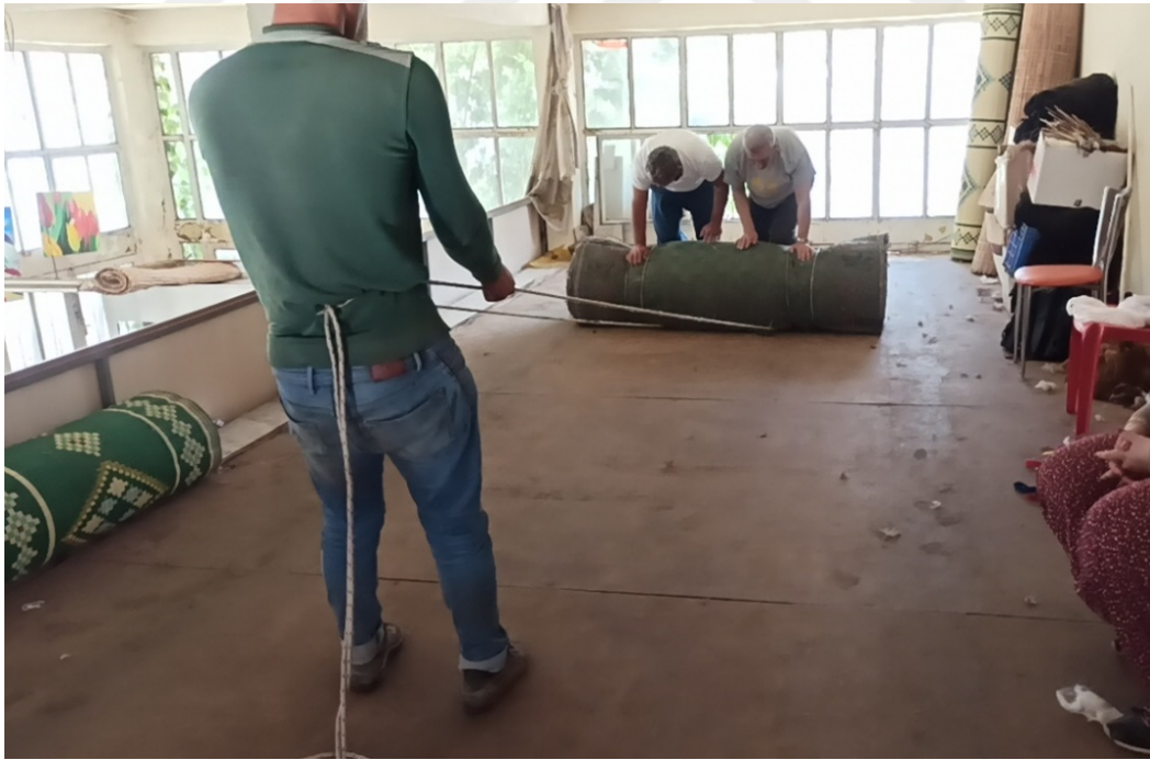
Görsel 3.62. Keçe Yer Yaygısı Yapım Aşamaları 25 (Ukbe Tayyib Dağdeviren, 15.07.2020) Çift taraflı bağlanan keçe rulo üçüncü bir kişiyi yardımıyla sıkıca dürlür.
