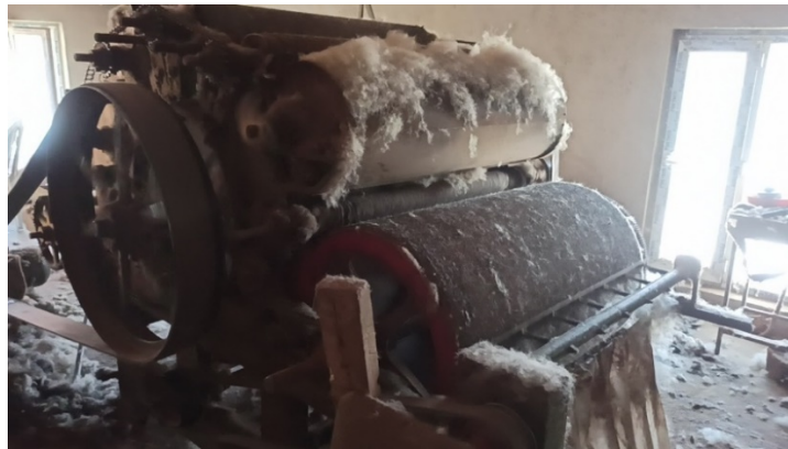
Görsel 3.10. Üçüncü Kat Yün Tarak Makinesi (Mine Dağdeviren,17.07.2020)
