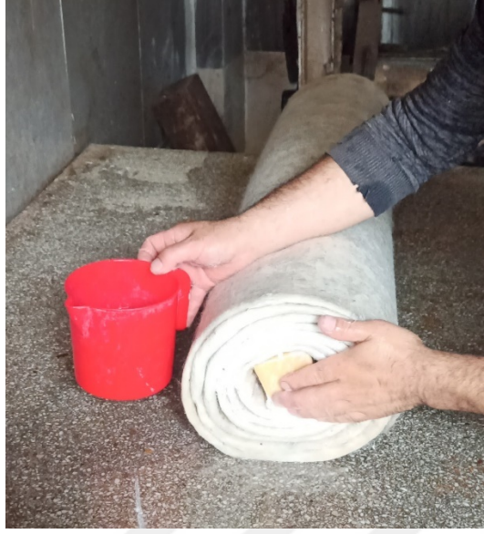
Görsel 3.84. Keçe Yer Yaygısı Yapım Aşamaları 47 (Mine Dağdeviren17.07.2020)
