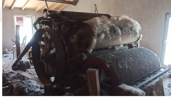
Görsel 3.30. Tarak Makinesi (Mine Dağdeviren 16.07.2020)
