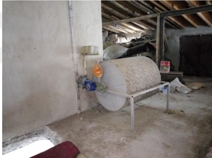
Görsel 3.12. Üçüncü Kat İnce Keçe Yüzey Oluşturma Makinesi (Mine Dağdeviren, 04.03.2019)
