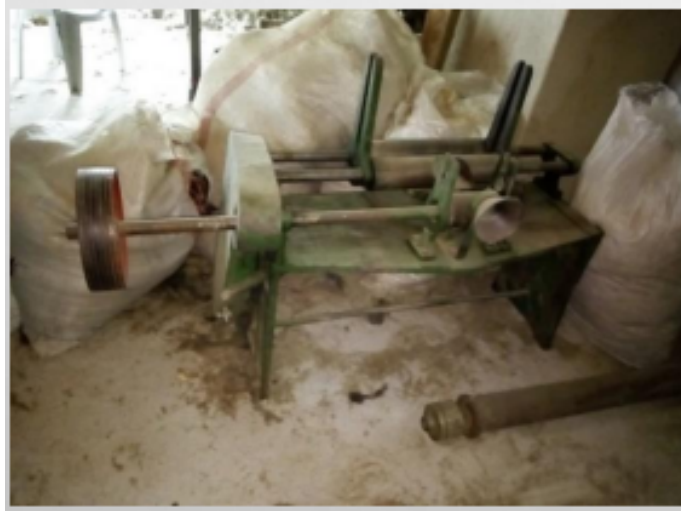
Görsel 3.11. Üçüncü Kat Fıtil Yapma Makinesi (Mine Dağdeviren,04.03.2019)
