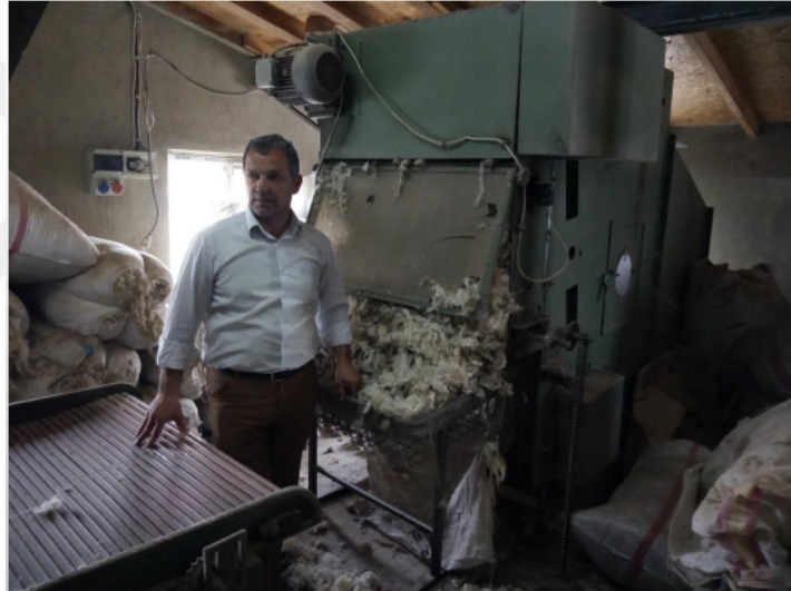
Görsel 3.9. Üçüncü Kat Yün Atma Makinesi (Mine Dağdeviren,04.03.2019)
