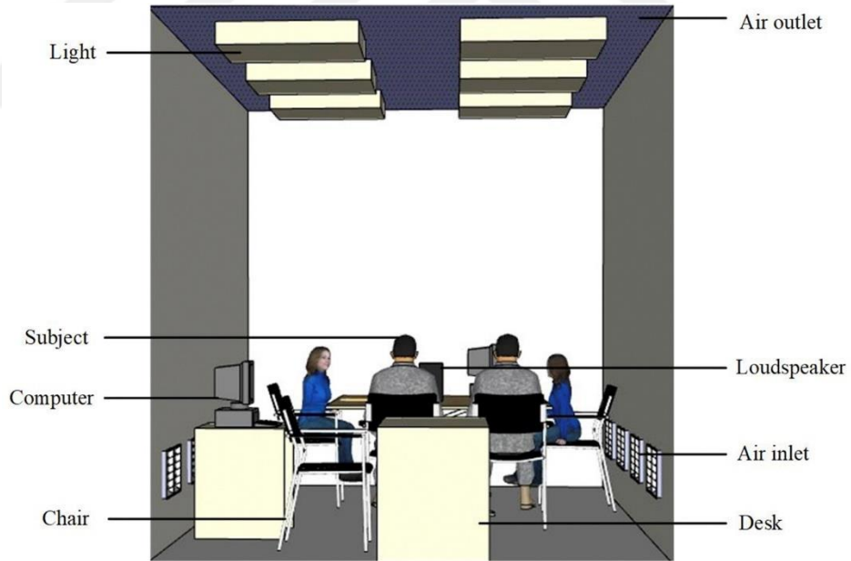
Şekil 2.15. Çalışmaların gerçekleştirildiği laboratuvar kesiti [87]
