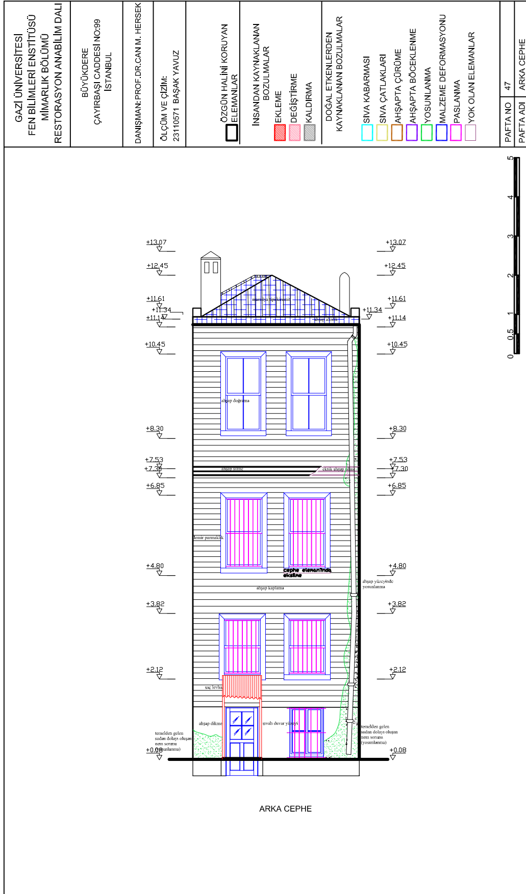
Şekil 5.47. Arka cephe değişim ve bozulmalar
