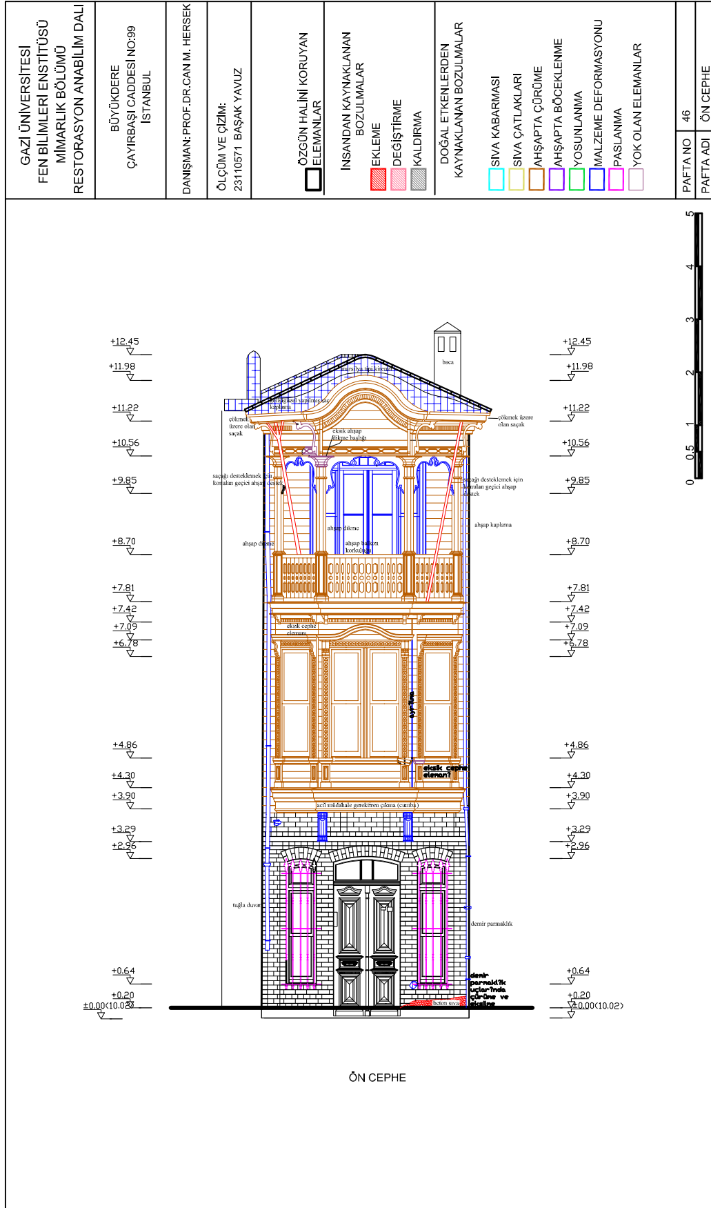
Şekil 5.46. Ön cephe değişim ve bozulmalar
