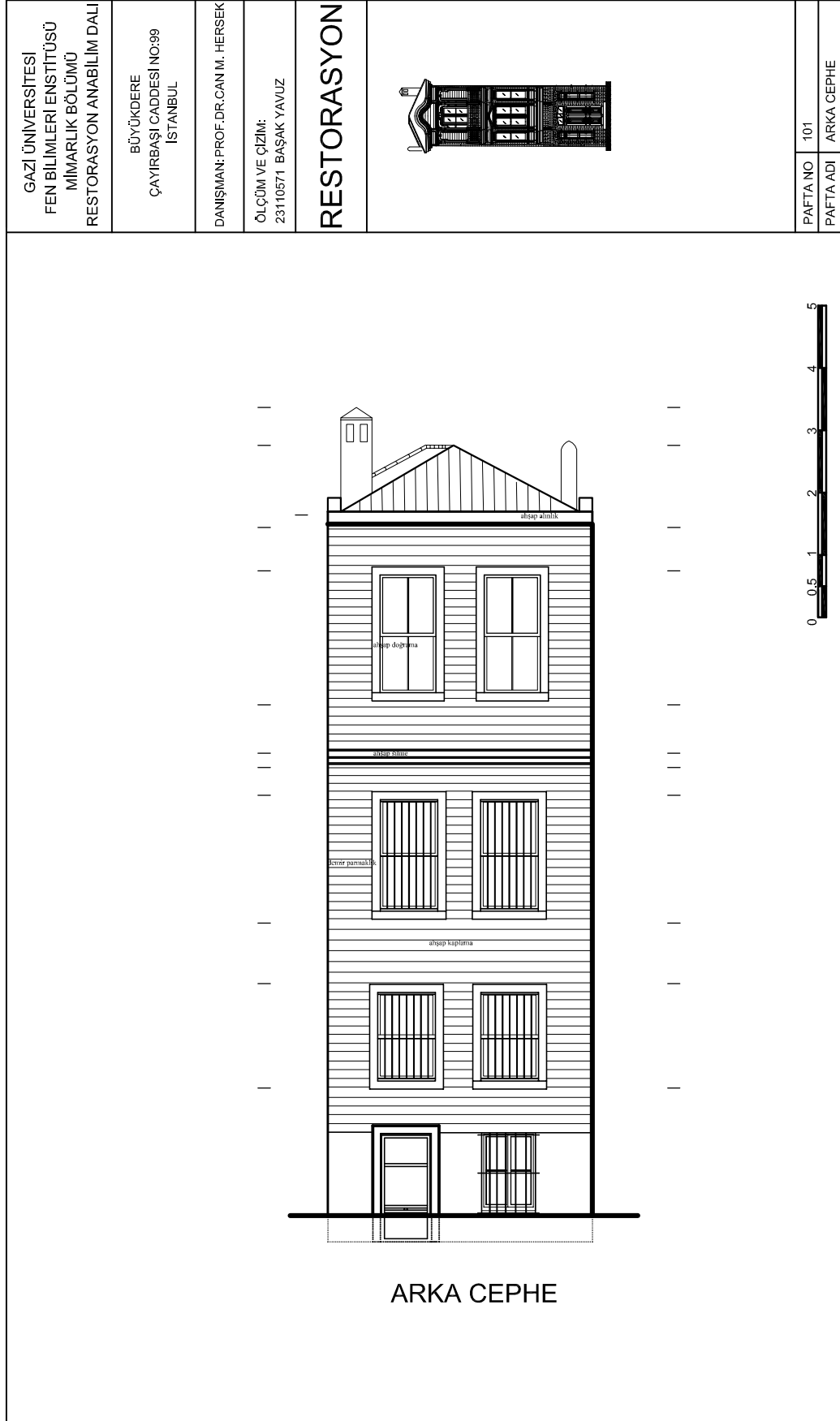
Şekil 8.19. Arka cephe restorasyon projesi
