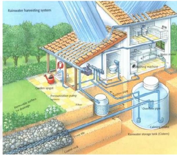
Şekil-26 Yağmur Suyu Depolama ve Kullanım Şeması (Url-15)
