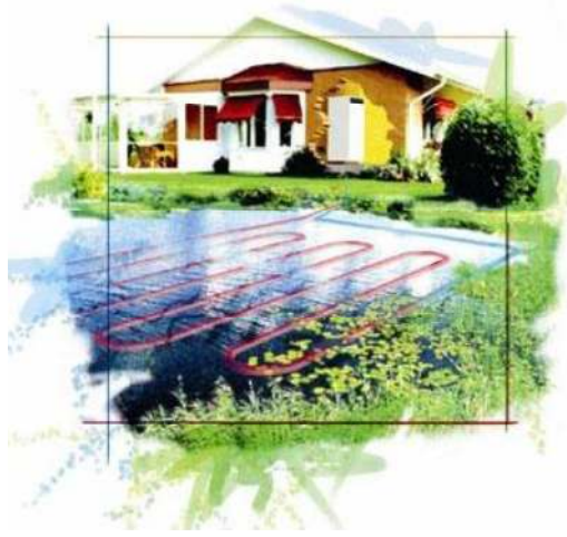
Şekil-17 Toprak Kaynaklı Isı Pompası (Url-11)
