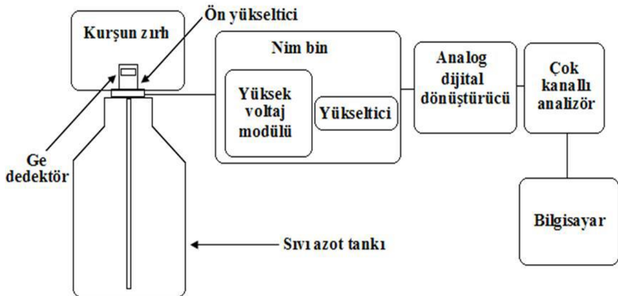
Şekil 3.15: Gama spektrometresinin şematik görünümü.
