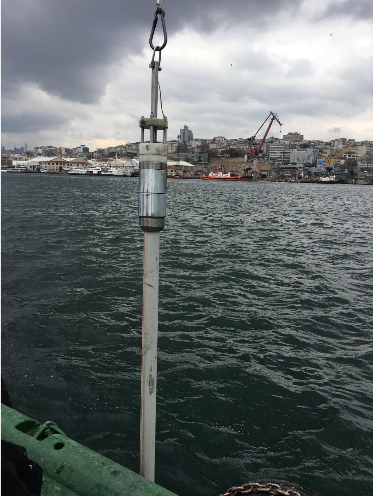
Şekil 3.2: Sediment karot örnekleme.
