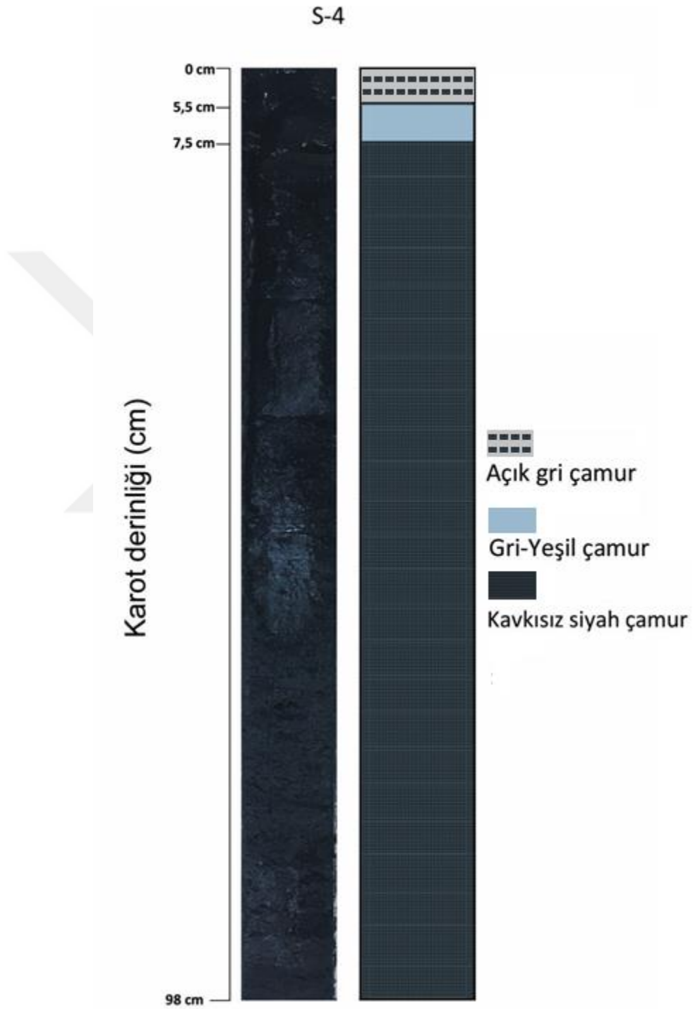
Şekil 4.4: S-4 karotunun litolojik özellikleri.
