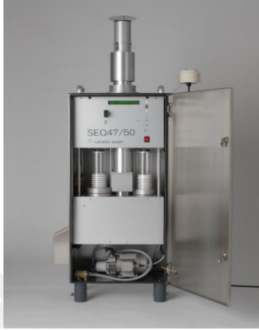
Şekil 3.1: Hava partikül madde (PM) ölçümünde kullanılan SEQ47/50 cihazı
