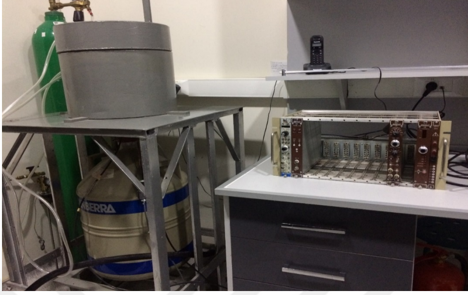
Şekil 3.7: Yüksek Çözünürlüklü Germanyum Dedektörlü Gama Spektrometresi
