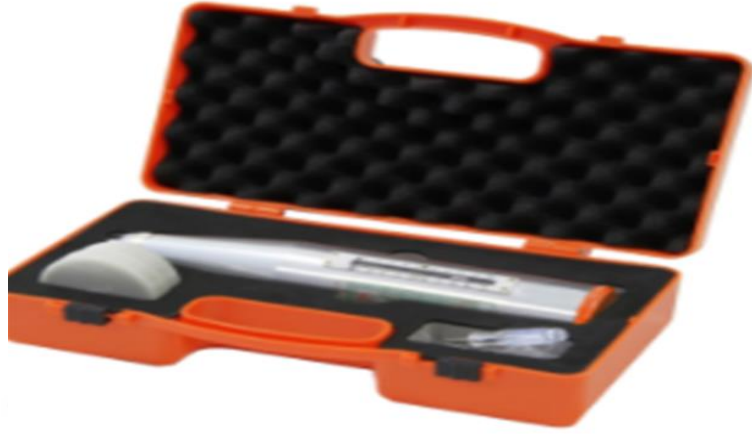
Resim 2.2. Beton test çekici
