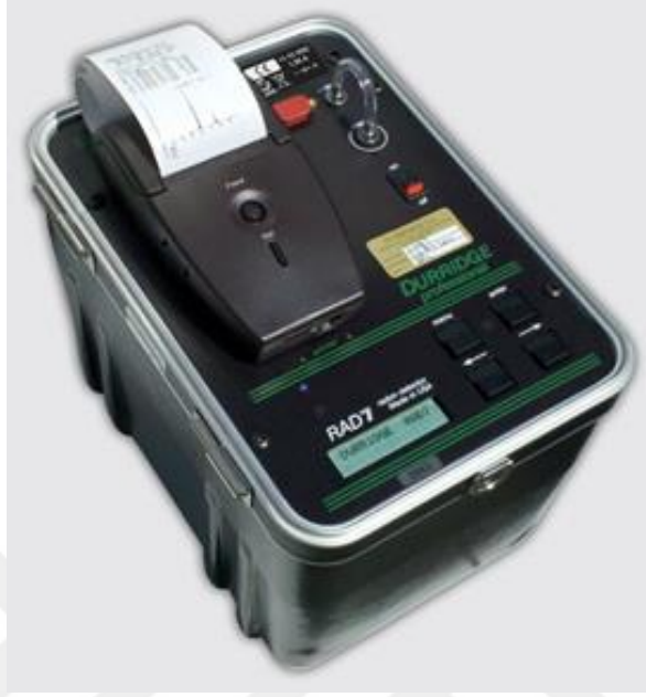
Şekil 2.3. RAD-7 (DurrIDGE Co, USA) radon detektörü [49].
