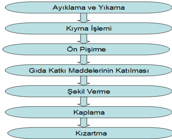
Şekil 10. Kroket üretimi işlem akış şeması
