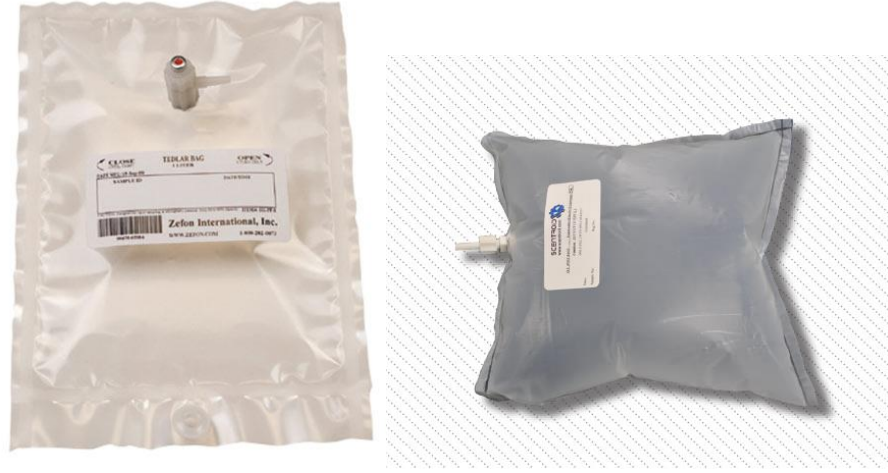
Şekil 3.1 Gaz numunesi için Tedlar torbalar (Cel Scientific corp, b.t.).
