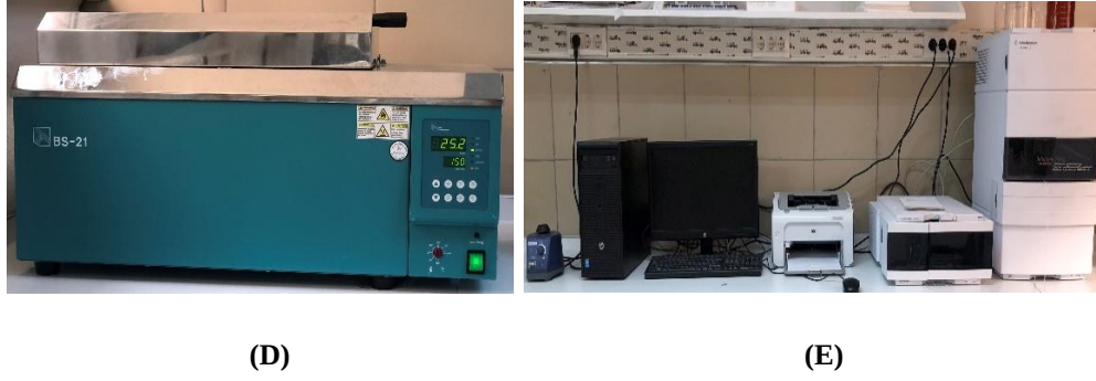
Şekil 3.3. Çalışmada kullanılan cihazlar: (A) Hassas terazi, (B) Ultra saf su cihazı, (C) Santrifüj, (D) Çalkalamalı sıcak su banyosu, (E) HPLC
