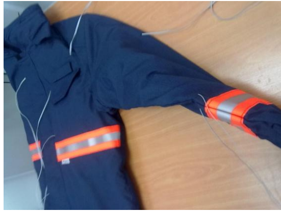
Şekil 4.6 Sağ dokunma algı düğmelerine kablo iletimi
