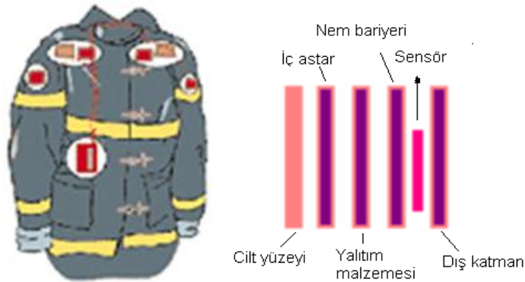
Şekil 2.43 Akıllı ceket yapısı
