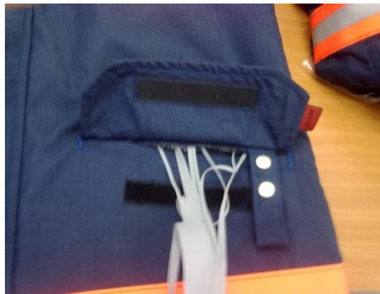
Şekil 4.5 Şerit kabloların dağılımı
