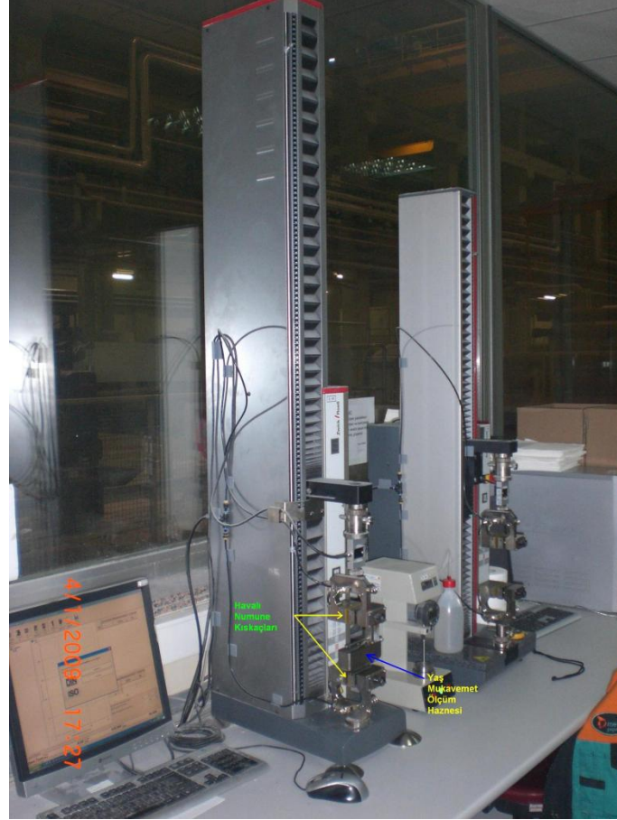
Şekil 2.5 Kopma testleri ve uzama testinin yapıldığı cihaz.
