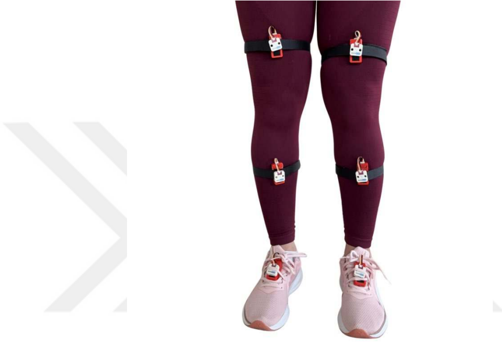
Şekil 3-13. IMU sensörlerinin ve M5StickC Plus mikro işlemcilerinin alt ekstremitedeki yerleşimleri.
