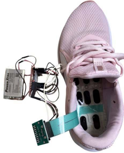
Şekil 3-11. Ayakkabı içerisine yerleştirilen tabanlık ve tabanlığın bağlı olduğu devre.
