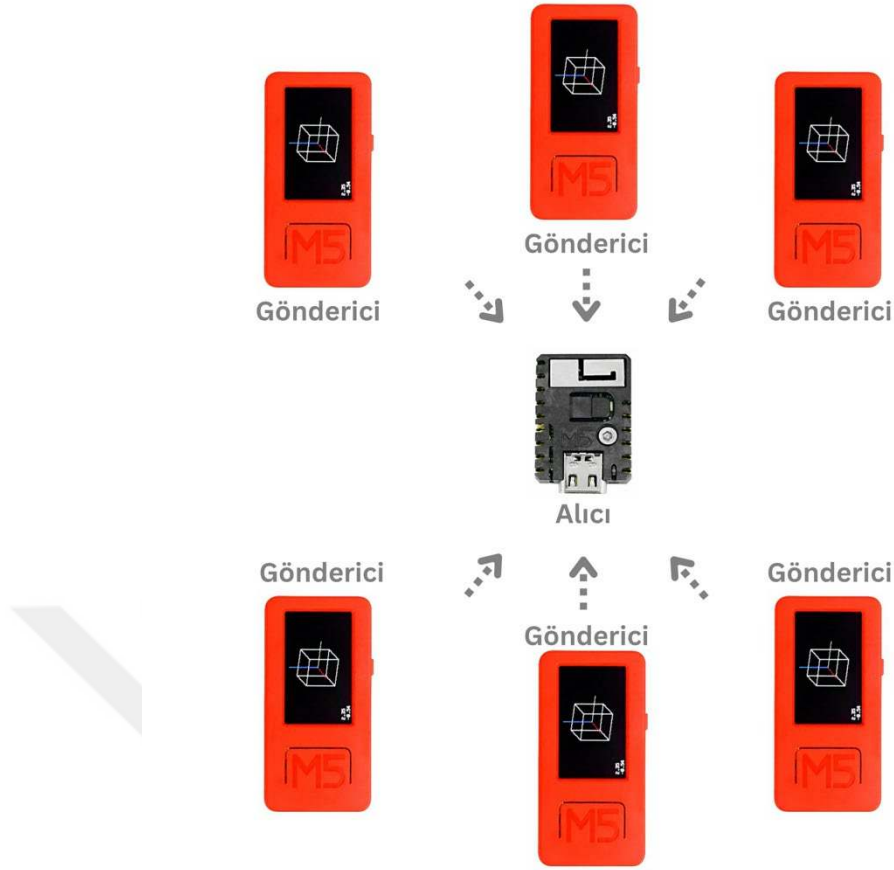
Şekil 3-7. ESP-NOW haberleşme ağında yer alan 6 adet gönderici ESP32 cihazı ve 1 adet alıcı ESP32 cihazı arasındaki iletişimin gösterimi.
