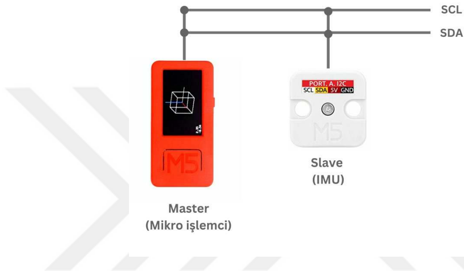
Şekil 3-4. M5StickC Plus ve M5 IMU pro cihazları arasındaki I2C haberleşmesinin gösterimi.
