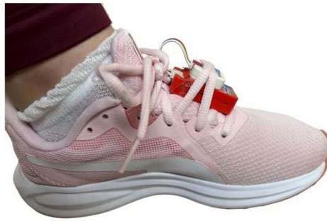
Şekil 3-14. IMU sensörü ve M5StickC Plus mikro işlemcisinin ayaktaki konumu.
