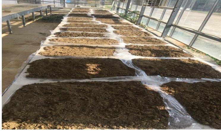
Şekil 3.4. Alınan toprak örneklerinin kurutulması sırasında genel görünümü
