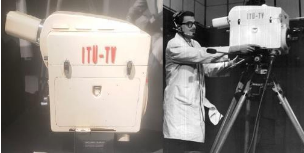
Şekil 4.27 İTÜ Televizyonu'nun emektar kameramanı Yüksek Mühendis Yücel Durusoy, Philips marka “süper ikonoskop” kamera ile (Fotoğraf Sinan Çakır, İTÜ Müzesi, 2024).
