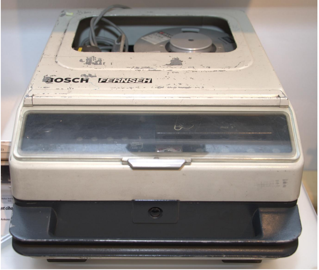
Şekil 4.21 Taşınabilir 1 inç Resim Kayıt Cihazı, Fotoğraf: Sinan Çakır, TRT Müzesi, Ankara, 2024.
