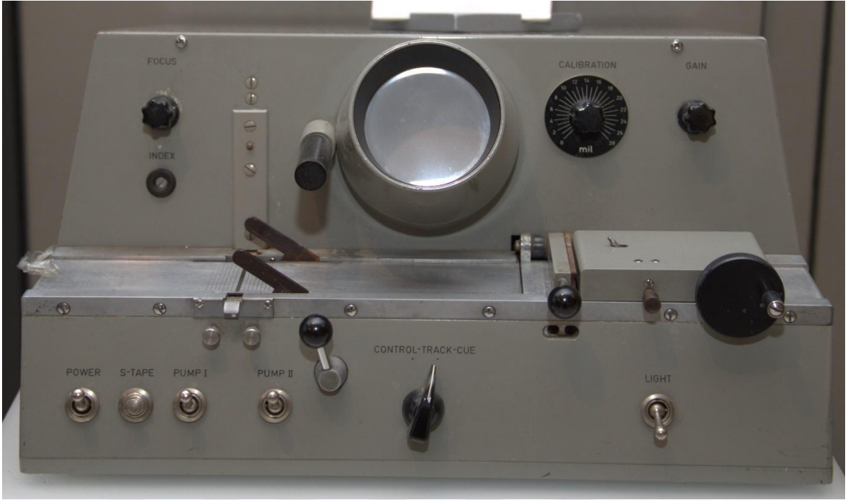
Şekil 4.18 2 inç Video Montaj Cihazı, Fotoğraf: Sinan Çakır, TRT Müzesi, Ankara, 2024.
