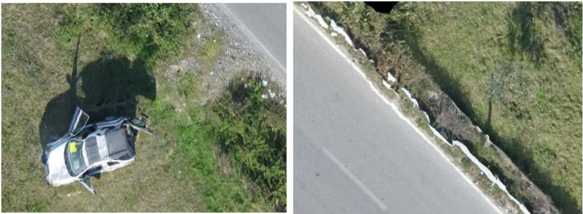
Şekil 33. Yazılım çıktısı ortofotolar üzerindeki bozulmalar (URL6)
