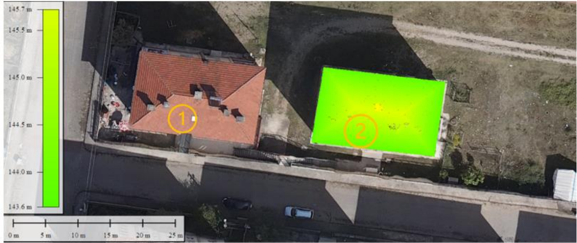
Şekil 79. Doğru 2 Ortofoto ile referans nokta bulutu karşılaştırması
