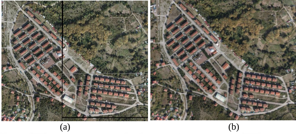
Şekil 61. (a) Klasik yöntemle üretilmiş ortofoto, (b) Doğru yöntemle üretilmiş ortofoto
