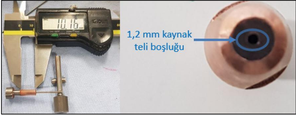
Resim 3.11 Kontak meme pim kalıbında preslenmiş pim görseli.
