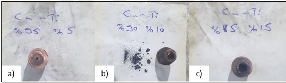
Resim 4.5 a) Cu- TiC (%95-5) Test 3 seri üretimde denemesi yapılacak kontak meme, b) Cu- TiC (%90-10) Test 3 seri üretimde denemesi yapılacak kontak meme, c) Cu- TiC (%85-15) seri üretim denemesi yapılmış kontak meme görselleri.
