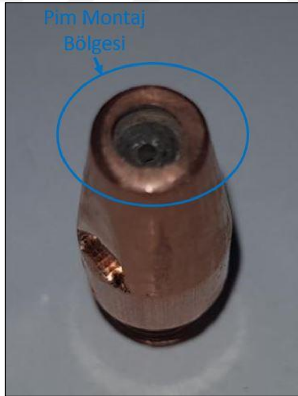
Resim 3.6 Aşınmış kontak meme pim montaj edilecek bölge görseli.
