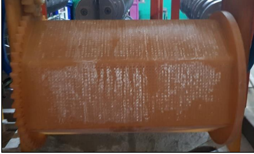
Resim 3.10 Kontak meme pim kalıbında pres yapılacak tozların karıştırıldığı tambur görseli.
