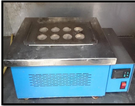
Şekil 3.24. Araştırmada kullanılan protein yakma ünitesi (Orijinal)
