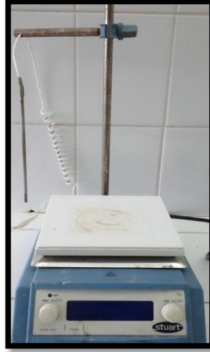
Şekil 3.18. Araştırmada kullanılan ısıtıcılı manyetik karıştırıcı (Orijinal)
