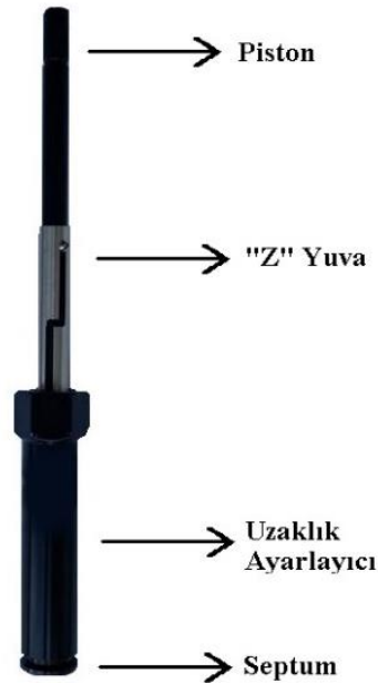
Şekil 1.1 Katı faz mikroekstraksiyon enjektörü (Kişisel arşiv, 2023)
