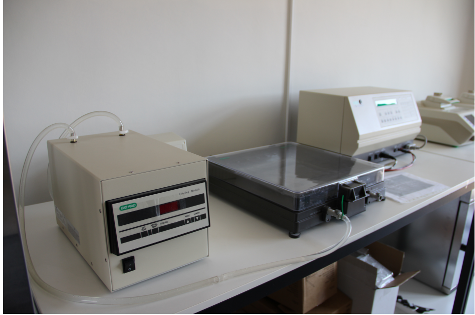
Şekil 3.4 PFGE işleminde kullanılan jel yürütme sistemi.
