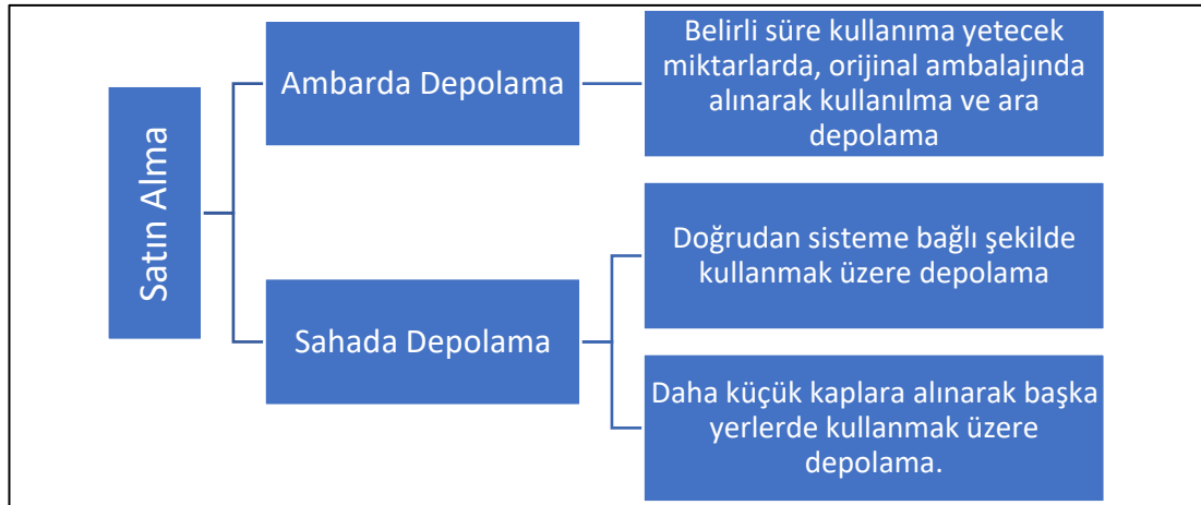
Şekil 5.1 Çiğli Atıksu Arıtma Tesisindeki kimyasal depolama şeması
