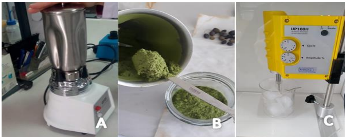
Şekil 3.3. Zeytin meyve ve yaprak ekstraktlarının eldesi A) Waring blendır ile öğütülme aşaması B) Öğütülen örnekler C) Sonikatör ile ekstre eldesi.
