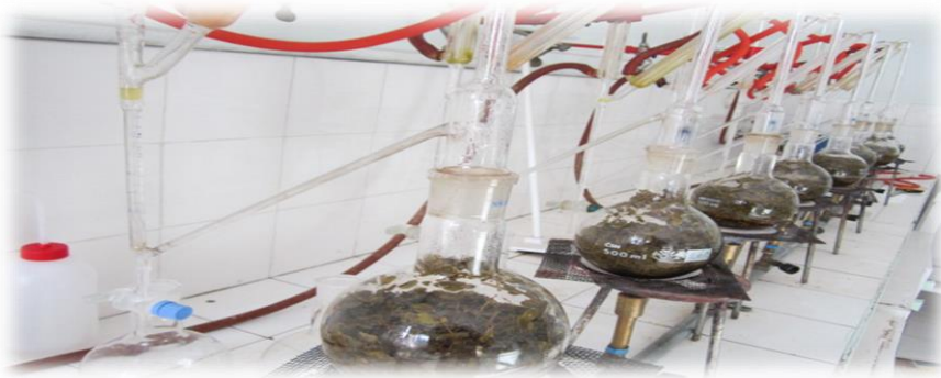
Şekil 3.2. Neo-Clevenger apareyi ile uçucu yağların elde edilmesi.
