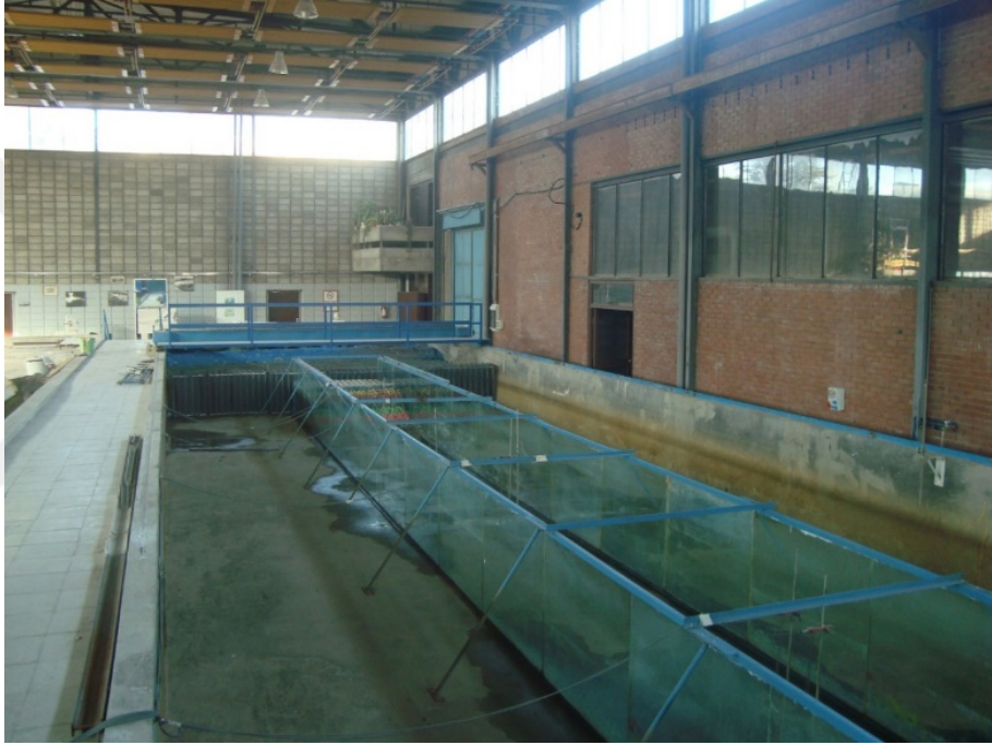
Şekil 4.1 Fiziksel modellerin yapıldığı Ortadoğu Teknik Üniversitesi, İnşaat Mühendisliği Bölümü, Deniz Mühendisliği Araştırma Merkezi Laboratuvarı dalga kanalı (Kişisel arşiv, 2016)
