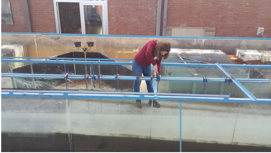
Şekil 4.5 Dalga sensörlerinin yerleştirilmesi (Kişisel arşiv, 2016)
