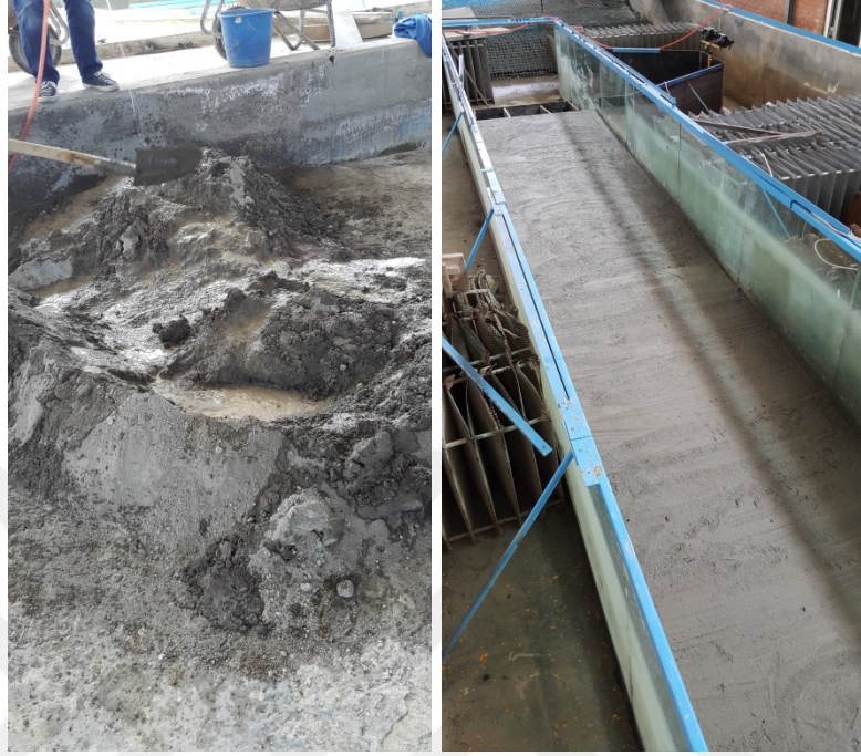
Şekil 4.3 Model önü taban eğiminin hazırlanışı (Kişisel arşiv, 2016)
