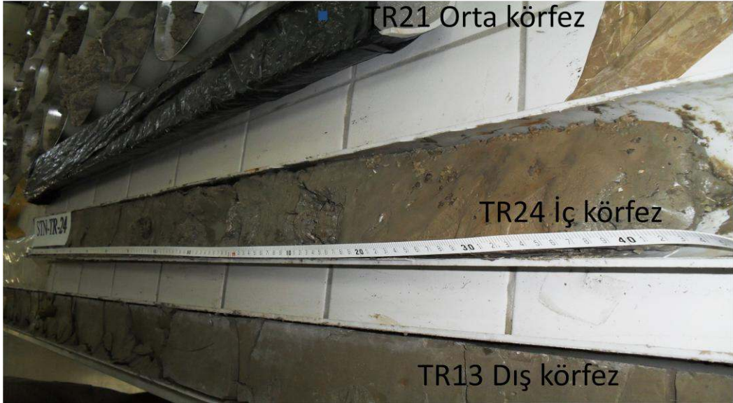
Şekil 2.2 R / V / K Piri Reis Araştırma gemisi serbest düşüş örnekleyicisi (Gravity Corer) ve alınan üç karot örneğinin görünümü.
