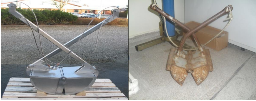
Şekil 2.3 Kullanılan yüzey örnekleyicisi' nin (grap sampler) fotoğrafı.
