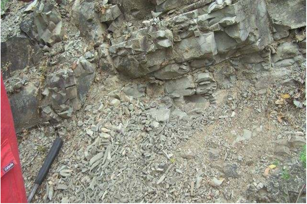
Şekil 2.9. Atbaşı Formasyonu'nun silisifiye killi kireçtaşı-marn ardalanması (Bakış, Kuzey yönüedir).
