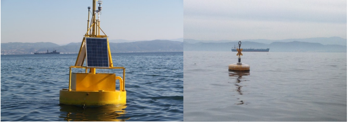
Şekil 5. (A) SUKOT şamandırası ve (B) T-Chain şamandırası.
