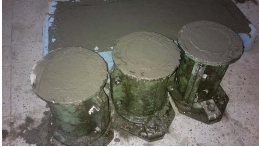
Şekil 5.2. Yarmada çekme deney numuneleri
