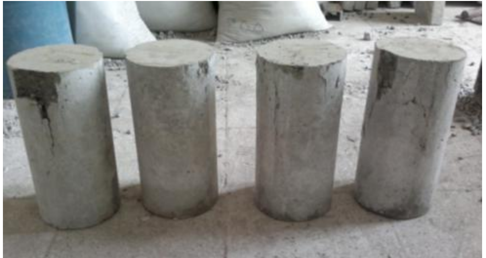
Şekil 5.6. Basınç deney numunelerin kırıdıktan sonra aldıkları şekiller
