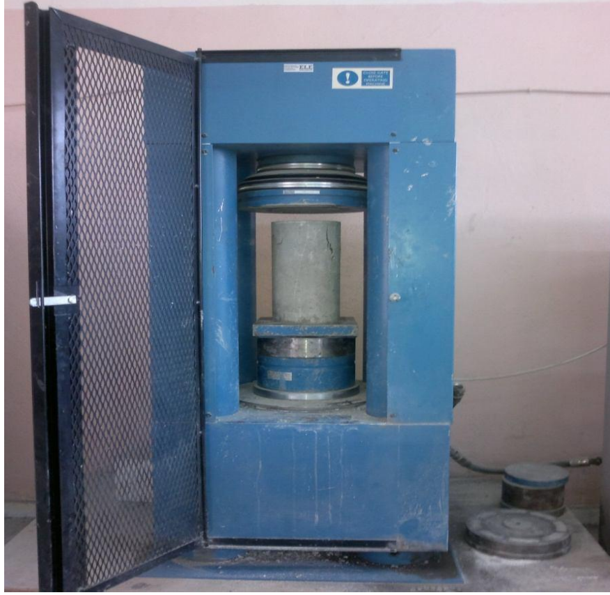
Şekil 5.5. Basınç dayanımının ölçülmesi
