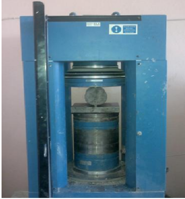
Şekil 5.8. Yarmada çekme dayanımı
