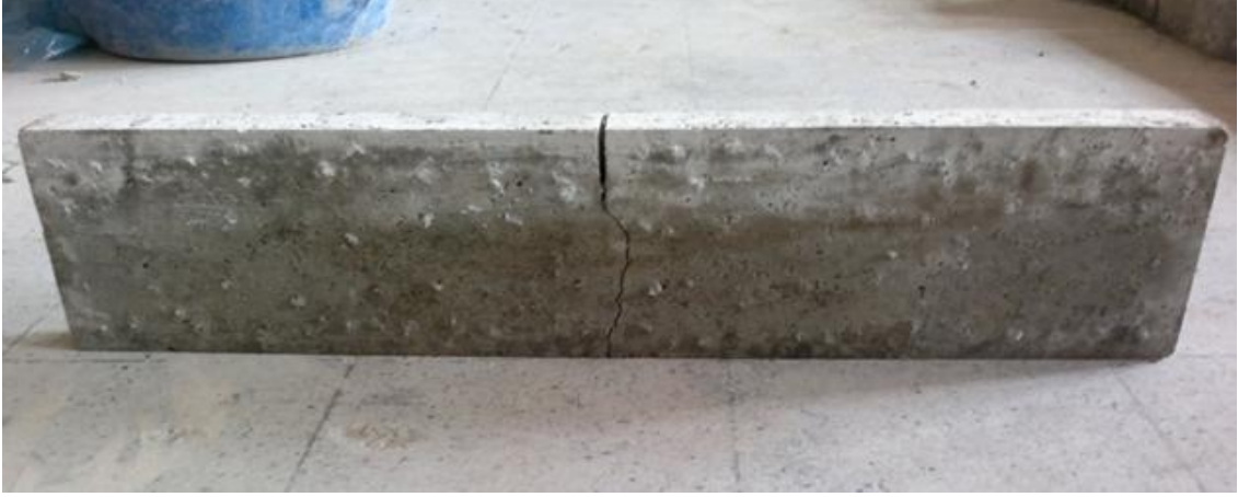
Şekil 5.11. İzod darbe deneyi sonucu kırılan numune
