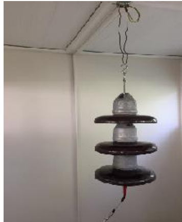
Şekil 4.87. Buzsuz üç elemanlı porselen zincir izolatör
