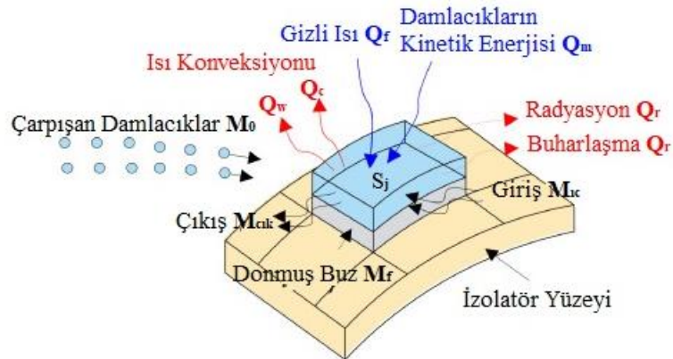
Şekil 2.16. İzolatörün j birimi üzerinde kütle ve enerji dengesinin şematik gösterimi [37]
