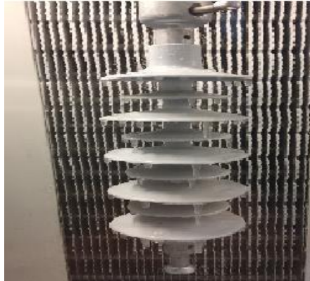
Şekil 4.115. Hafif buzlu silikon izolator
