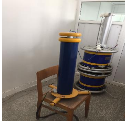
řekil 4.2. Gerilim bölücü ve yüksek gerilim transformatörü
