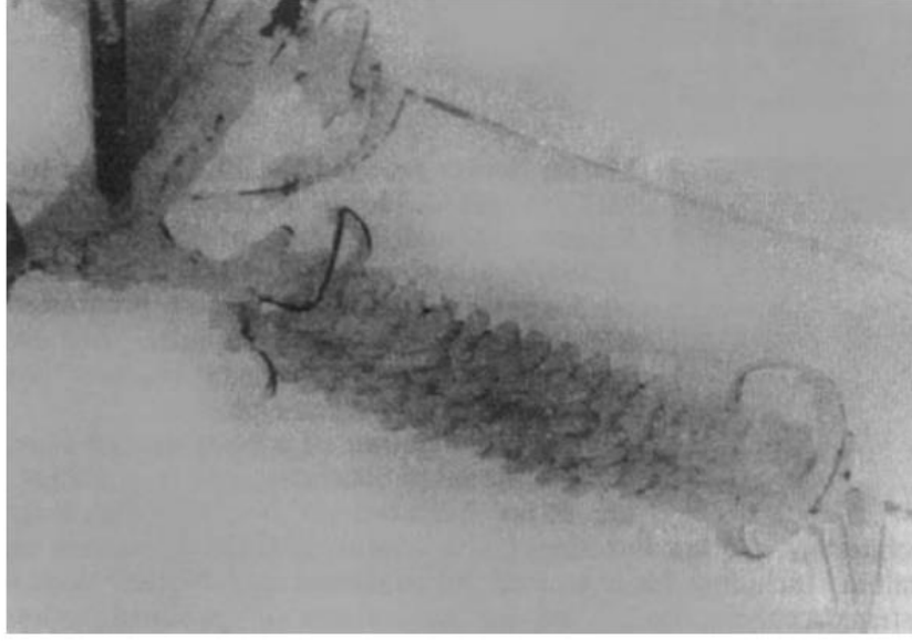
Şekil 2.9. İzolatör çifti üzerinde buz birikimi [34]
