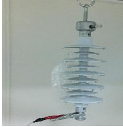
Şekil 4.124. Buzlu silikon izolatör
