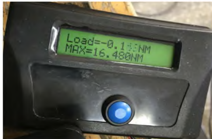
řekil 3.9. Dinamometre yk gstergesi
