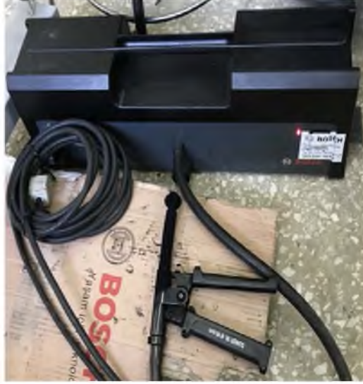
Şekil 3.12. Egzoz gazı duman koyuluğu ölçüm cihazı
