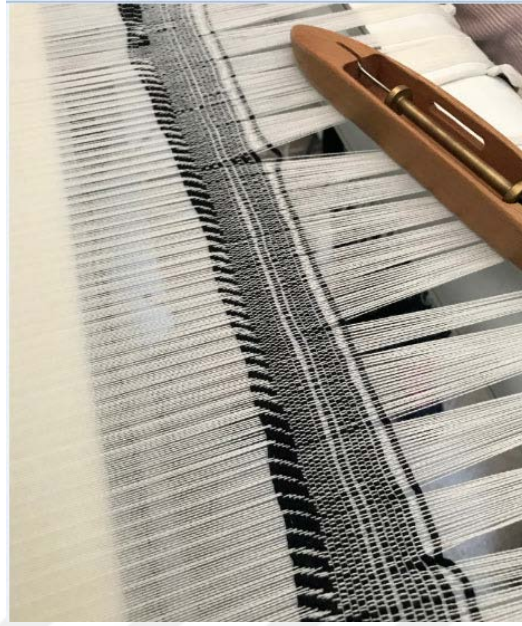
Resim 6- Bilgisayardan tezgaha aktarılan desenin dokunma süreci (Çukurova Üniversitesi, Güzel Sanatlar Fakültesi,Tekstil ve Moda Tasarımı Bölümü, Ekim 2018).
