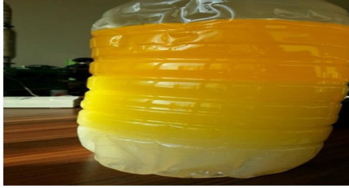
Şekil 5.10. Yıkanmış biyodizeldeki faz ayrımı
