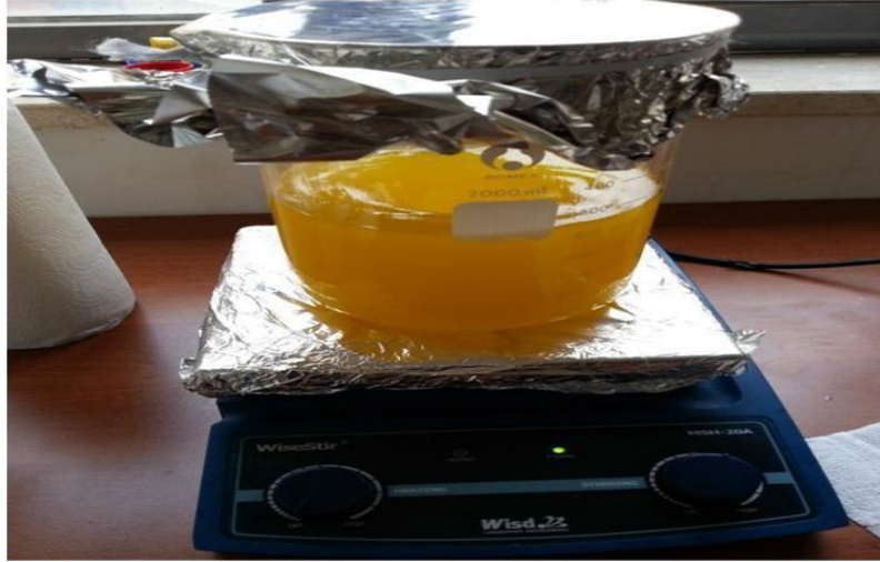
Şekil 5.7. Katalizör ve metil alkol katılarak ısıtılan yağ
