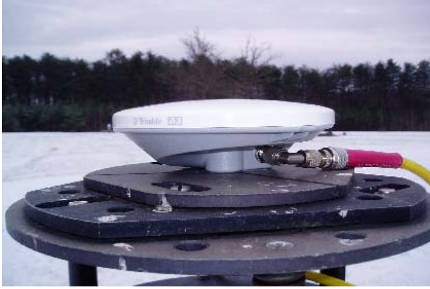
Şekil 3.4 Trimble-Zephyr (L1) A3 anteni [3]
