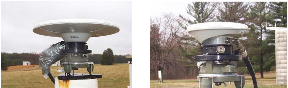
Şekil 5.2 Ölçümlerde kullanılan jeodezik GPS antenleri
