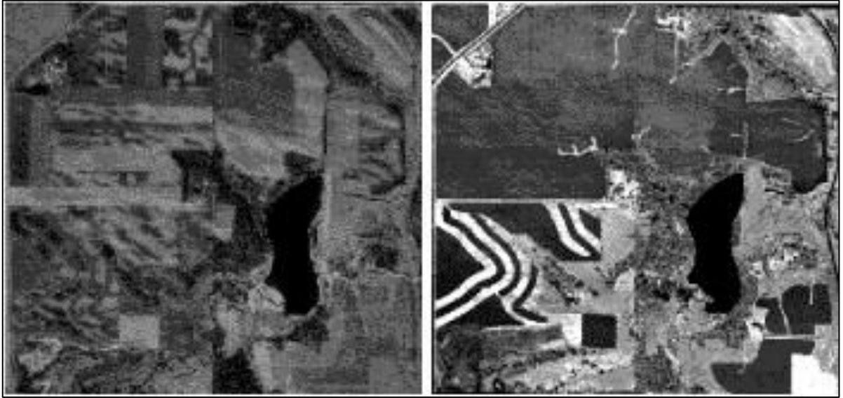
Şekil 27. Ortofoto görüntü (solda), LiDAR intensity görüntüsü (sağda) (Environmental Systems Research Institute (2018)'den alınmıştır.)
