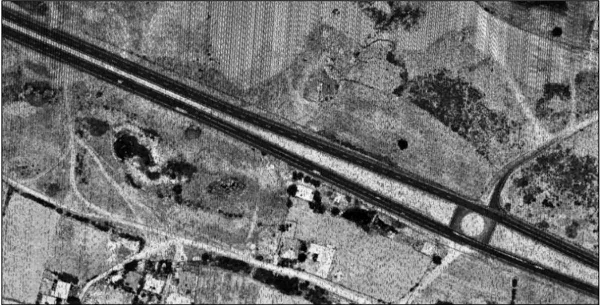
Şekil 30. Çalışma alanından bir intensity nokta bulutu verisi örneği
