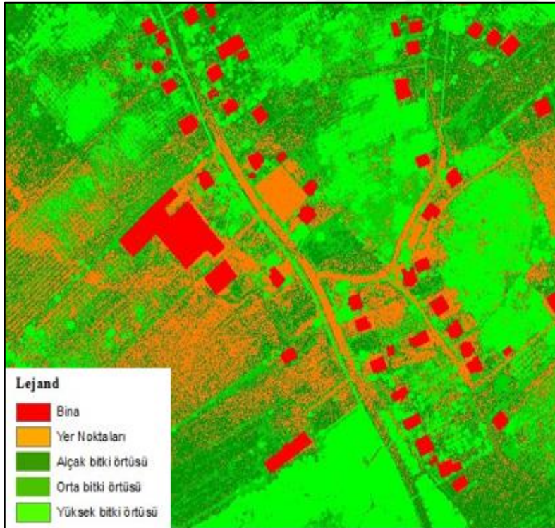
Şekil 17. Sınıflandırılmış nokta bulutu örneği
