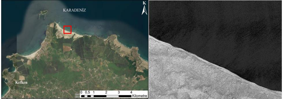
Şekil 32. Kara ve su yüzeyi noktalarının intensity olarak görüntülenmesi örneği
